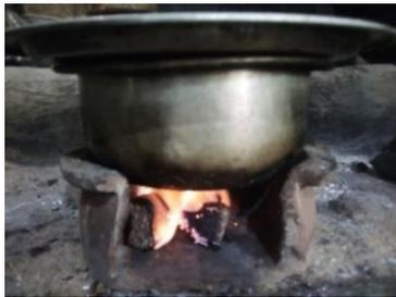
Fig 9. Boiling test
